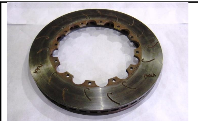
J5-1) Disque de frein avant Front brake disc
