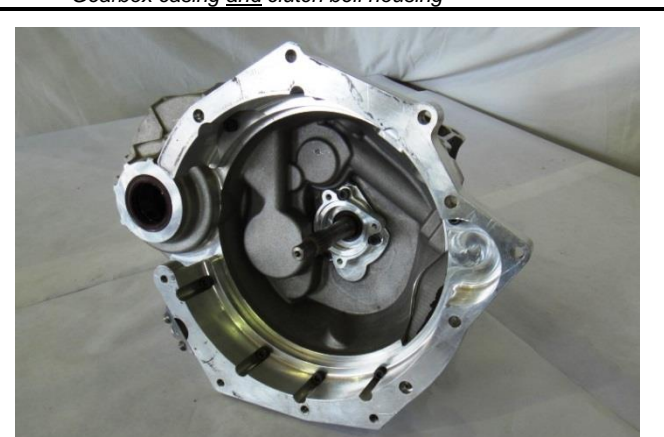
F2-2) Carter de boîte de vitesses et cloche d'embrayage Gearbox casing and clutch bell housing
