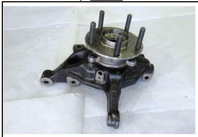
VII-D1) Moyeu de roue – dimensions caractéristiques Wheel hub – typical dimensions
