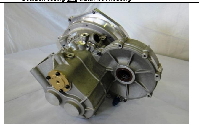
F2-1) Carter de boîte de vitesses et cloche d'embrayage Gearbox casing and clutch bell housing
