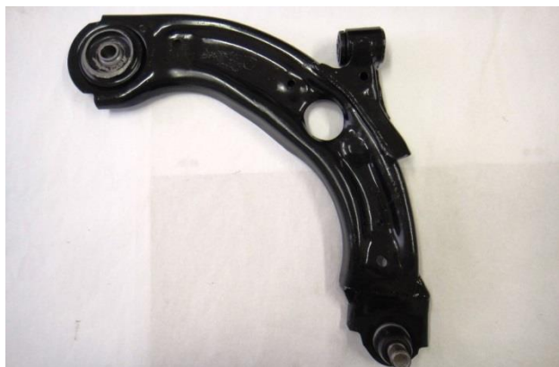
G5-1) Triangle/bras complet – déposé Complete wishbone/arm – dismounted
