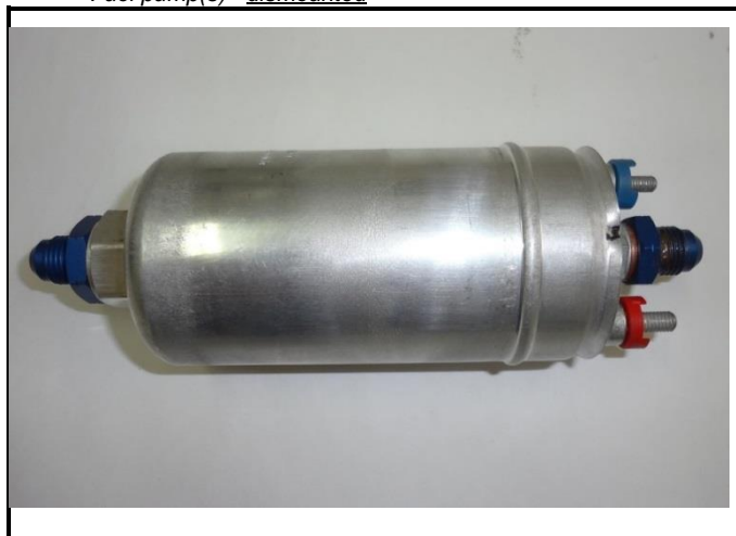
D2-1) Pompe(s) à carburant - déposée Fuel pump(s) - dismounted
