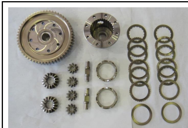
F4-4) Différentiel démonté Differential dismantled
