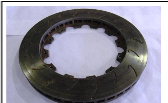
J5-2) Disque de frein avant Front brake disc
