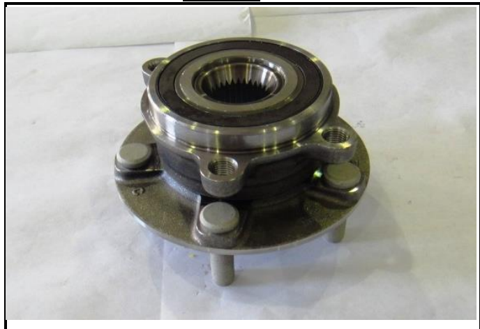
G4-1) Moyeu de roue nu – déposé Bare wheel hub – dismounted
