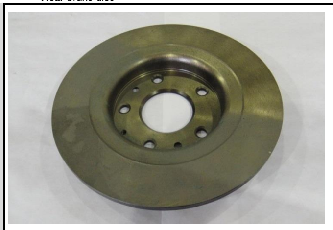
K5-4) Disque de frein arrière Rear brake disc
