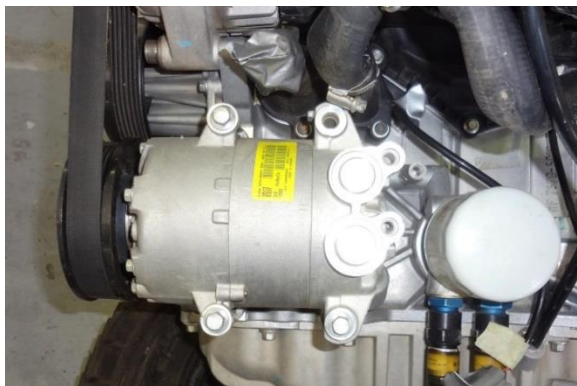
L3-2) Compresseur de climatisation - monté Air conditioning compressor - mounted
