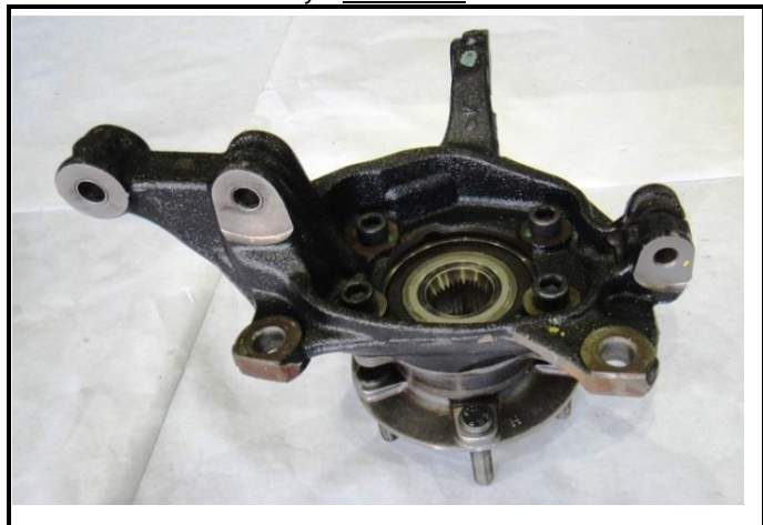
G4-1) Moyeu de roue nu – déposé Bare wheel hub – dismounted
