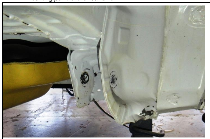
Liaison caractéristique de l'essieu arrière Typical joint of the rear axle
