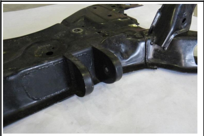
G3-1) Porte moyeu assemblé – déposé Hub carrier assembly – dismounted
