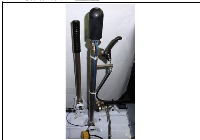
F2-6) Système de refroidissement complet - monté Complete cooling system - mounted
