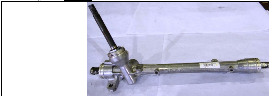
J11-1) Colonne de direction - déposée Steering column - dismounted
