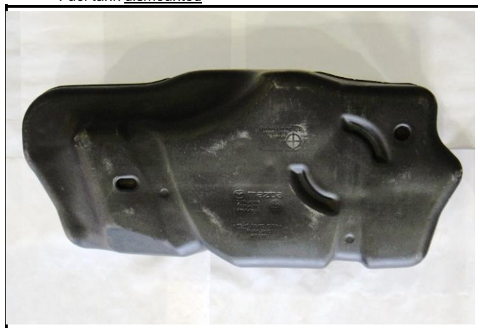
D1-2) Réservoir de carburant déposé Fuel tank dismounted
