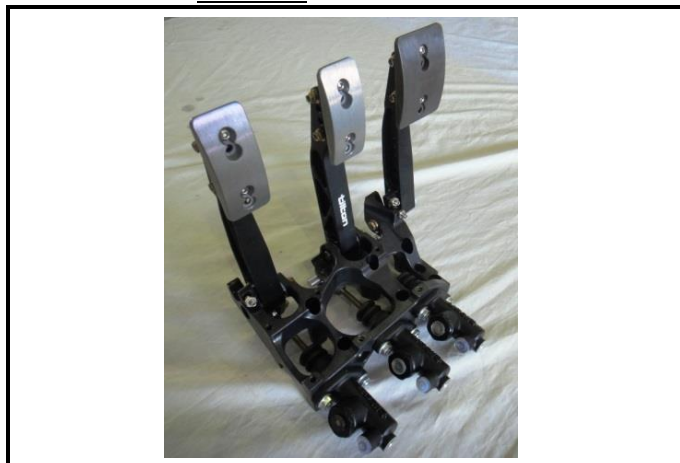
L2-2) Pédalier - déposé vu de profil Pedal box - dismounted seen from side
