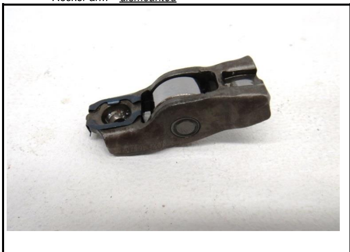
C10-5) Culbuteur – démonté
