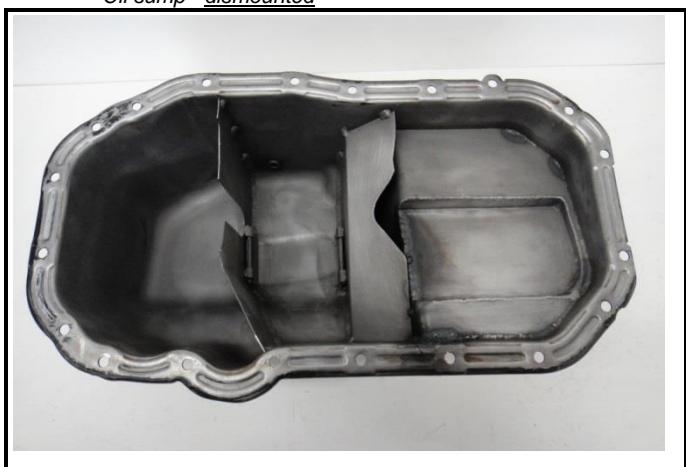
C14-1) Carter d'huile - déposé Oil sump - dismounted
