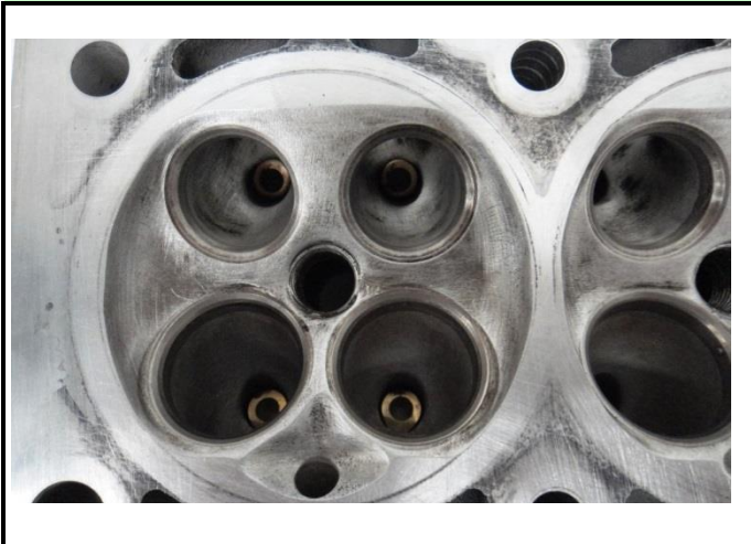
C8-7) Chambre de combustion Combustion chamber
