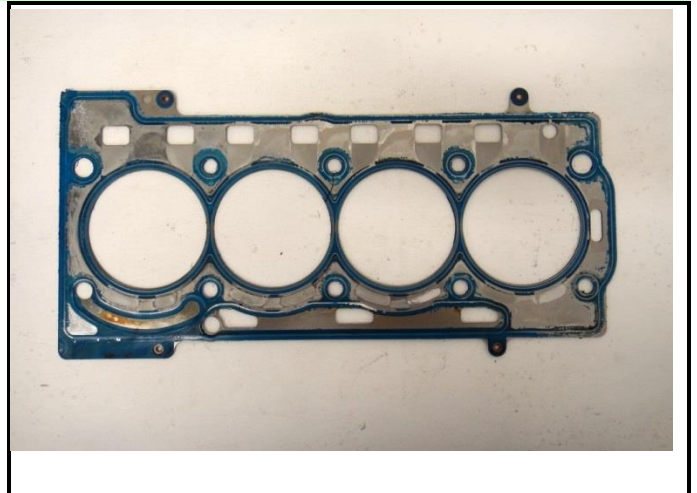
C8-12) Joint de culasse – déposé (endroit de mesure) Cylinderhead gasket – dismantled (location of measurement)
