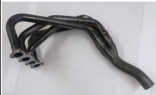
C12-1) Collecteur d'échappement - déposé Exhaust manifold - dismounted
