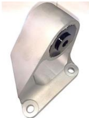
C2-3) Support moteur 3 déposé (photo) Engine support 3 dismounted (photo)
