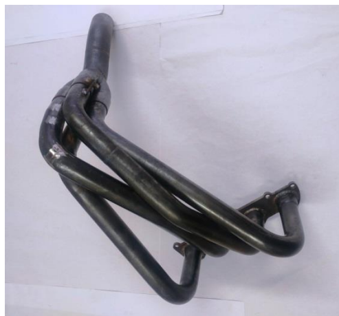
C12-2) Collecteur d'échappement - déposé Exhaust manifold - dismounted
