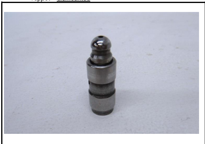
C10-6) Poussoir – démonté Tappet – dismounted
