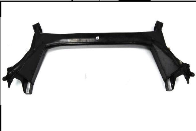
H2-2) Berceau de fixation des pièces d'essieu – déposé
