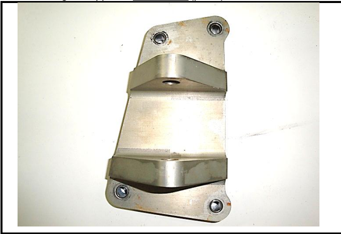
C2-3) Support moteur 2 déposé (photo) Engine support 2 dismounted (photo)
