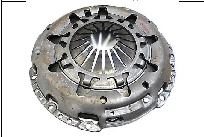
F1-2) Groupe de pression démonté sans disque(s) Pressure unit dismounted without disc(s)
