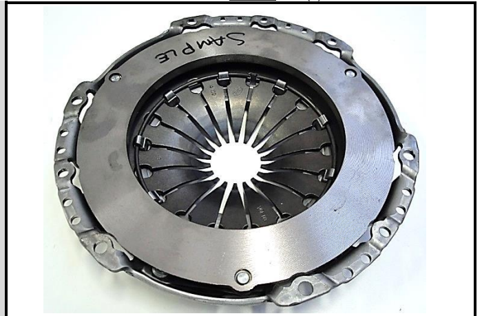
F1-3) Groupe de pression démonté sans disque(s) Pressure unit dismounted without disc(s)
