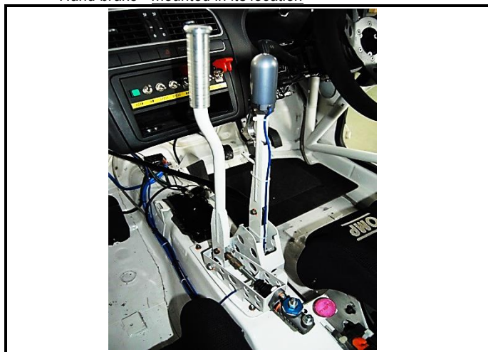
J8-1) Frein à main - monté dans son emplacement Hand brake - mounted in its location
