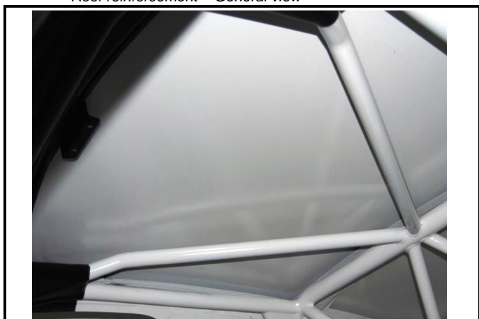
SC-23) Renfort de toit – Vue d'ensemble Roof reinforcement – General view
