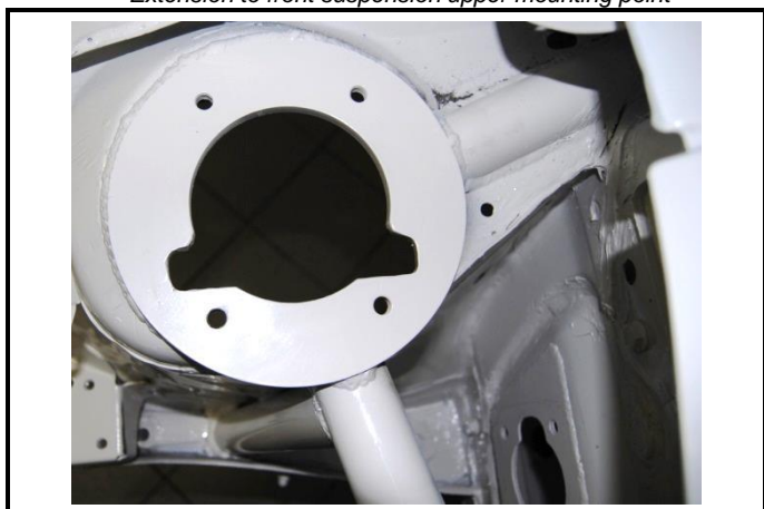
SC-33) Extension vers point d'ancrage sup. de suspensions avant Extension to front suspension upper mounting point
