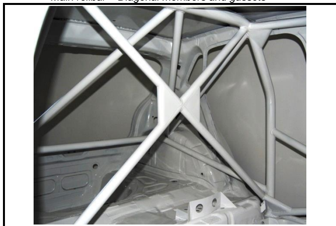
SC-16) Entretoises diagonales – Jonction avec arceau principal Diagonal members – Junction with main rollbar
