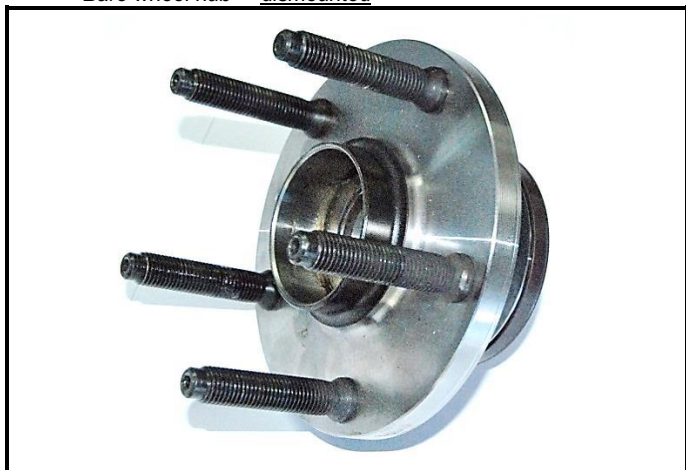
H4-1) Moyeu de roue nu – déposé Bare wheel hub – dismounted
