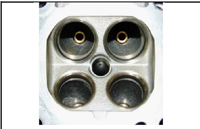
C8-7) Chambre de combustion Combustion chamber
