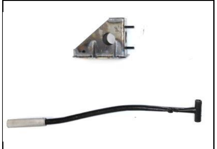
J8-2) Frein à main - déposé Hand brake - dismounted
