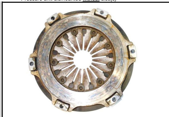
F1-3) Groupe de pression démonté sans disque(s) Pressure unit dismounted without disc(s)
