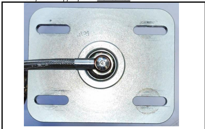
G1-5) Platine supérieure de suspension - déposée Suspension upper plate - dismounted
