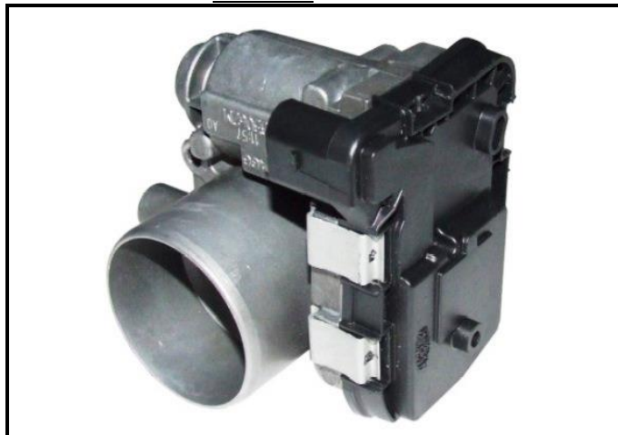
C11-4) Boitier papillon - déposé Throttle unit - dismounted
