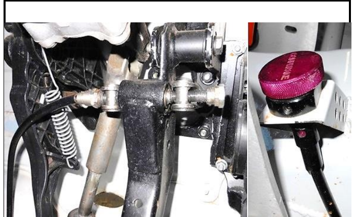
J7-2) Régulateur de freinage - monté dans son emplacement Brake regulator - mounted in its location
