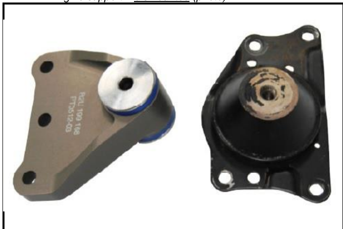
C2-2) Support moteur 2 déposé (photo) Engine support 2 dismounted (photo)
