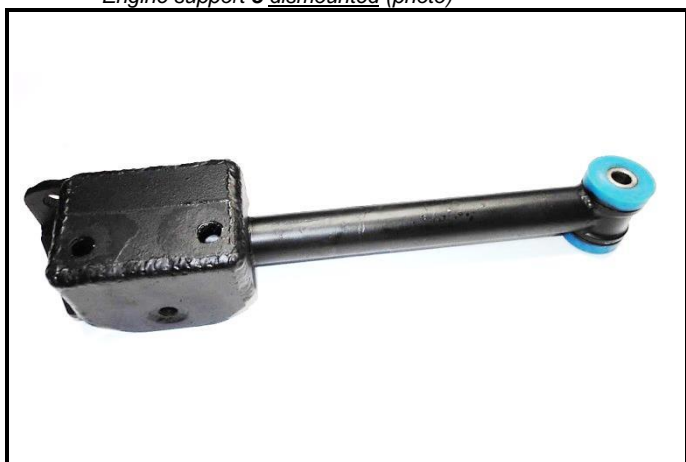
C2-3) Support moteur 3 déposé (photo) Engine support 3 dismounted (photo)
