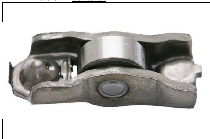
C10-5) Culbuteur - démonté Rocker arm - dismounted
