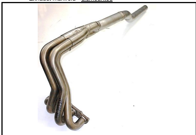
C12-1) Collecteur d'échappement - déposé Exhaust manifold - dismounted
