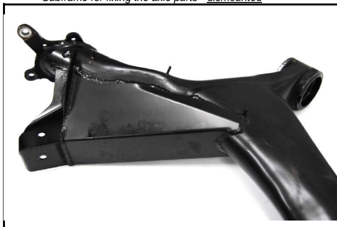
H2-2) Berceau de fixation des pièces d'essieu – déposé Subframe for fixing the axle parts - dismounted
