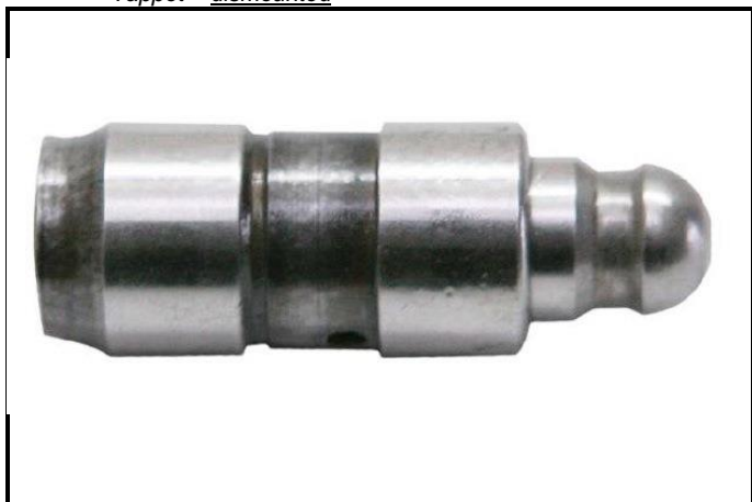
C10-6) Poussoir – démonté Tappet – dismounted
