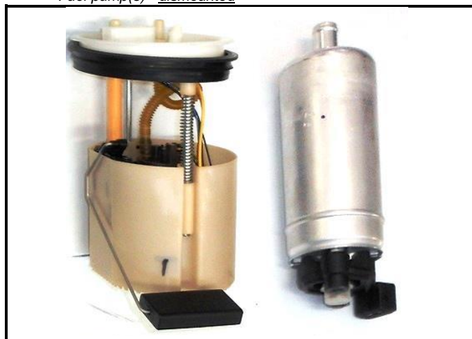
D2-1) Pompe(s) à carburant - déposée Fuel pump(s) - dismantled
