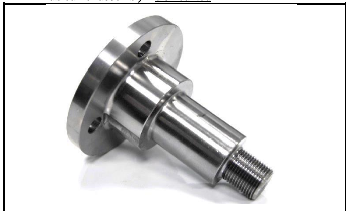
H4-1) Moyeu de roue nu – déposé Bare wheel hub – dismounted
