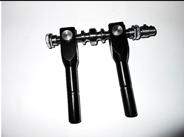
J7-1) Régulateur de freinage - déposé Brake regulator - dismounted
