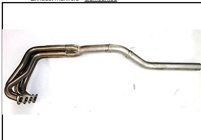
C12-2) Collecteur d'échappement - déposé Exhaust manifold - dismounted
