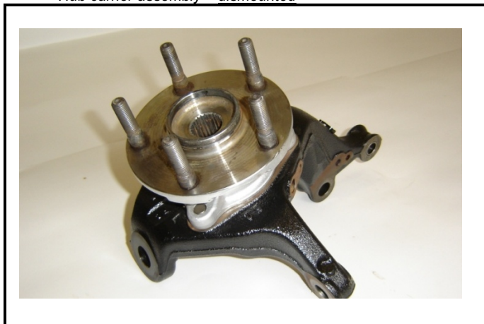
G4-1) Moyeu de roue nu – déposé Bare wheel hub – dismantled
