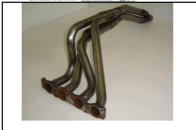
C12-1) Collecteur d'échappement - déposé Exhaust manifold - dismounted Type 1
