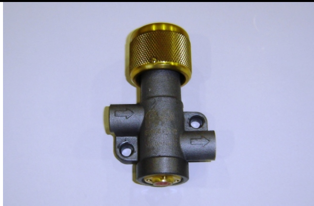
J7-1) Régulateur de freinage - déposé Brake regulator - dismounted
