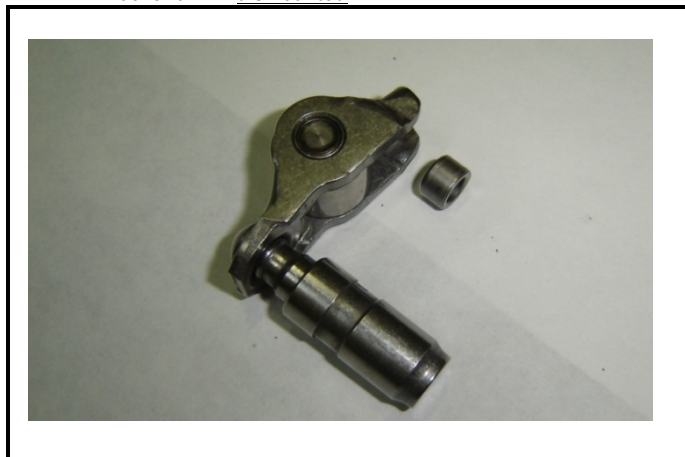
C10-5) Culbuteur - démonté Rocker arm - dismantled
