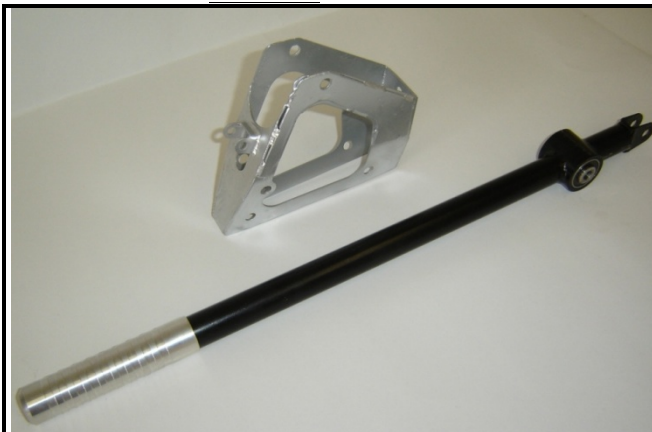
J8-2) Frein à main - déposé Hand brake - dismounted
