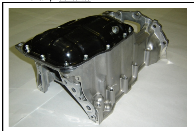
C14-2) Carter d'huile - déposé Oil sump - dismounted
