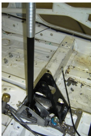
J8-1) Frein à main - monté dans son emplacement Hand brake - mounted in its location
