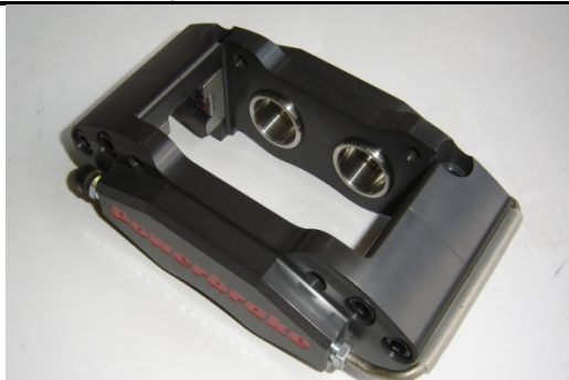
J4-1) Etrier de frein avant Front brake caliper
