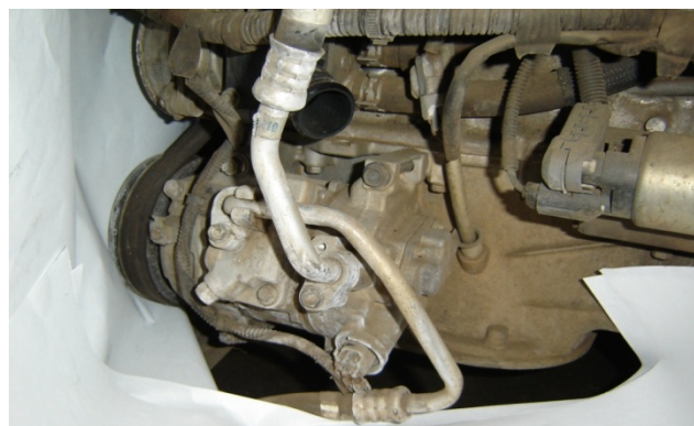
L3-2) Compresseur de climatisation - monté Air conditioning compressor - mounted
