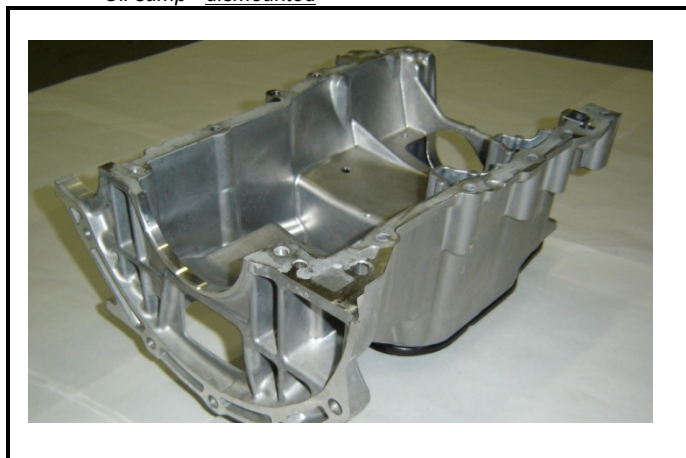
C14-1) Carter d'huile - déposé Oil sump - dismounted
