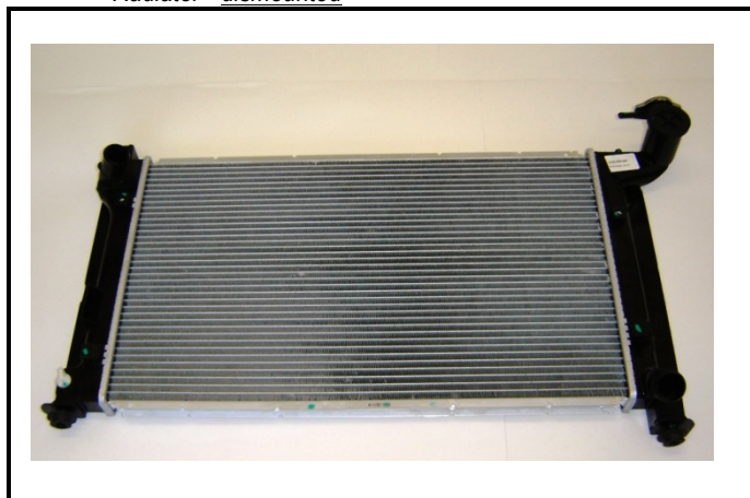
C13-1) Radiateur - démonté Radiator - dismounted
