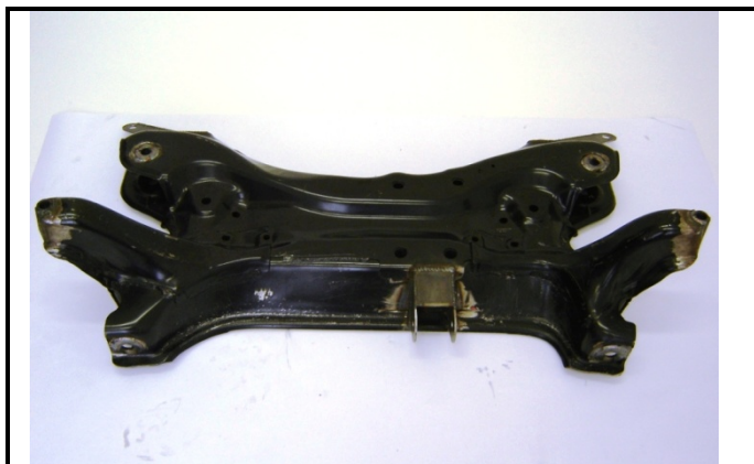
G2-1) Berceau de fixation des pièces d'essieu – déposé Subframe for fixing the axle parts - dismounted
