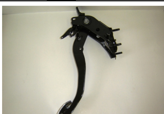
L2-2) Pédalier - déposé vu de profil Pedal box - dismounted seen from side
