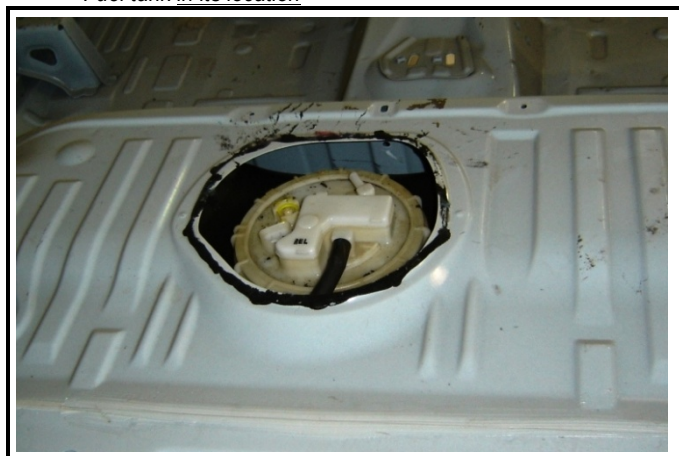
D2-1) Pompe(s) à carburant - déposée Fuel pump(s) - dismantled
