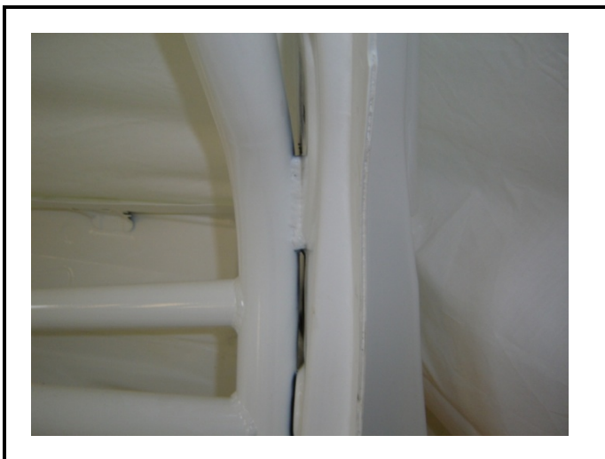
SC-5) Arceau avant ou latéral – Fixation au montant A Front or lateral rollbar – Fixing to A-pillar
