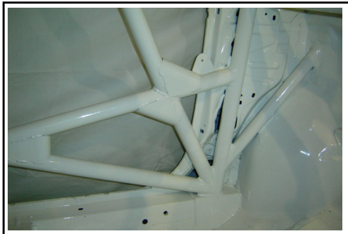
SC-22) Entretoises de portes – Jonction avec arceau principal Doorbars – Junction with main rollbar
