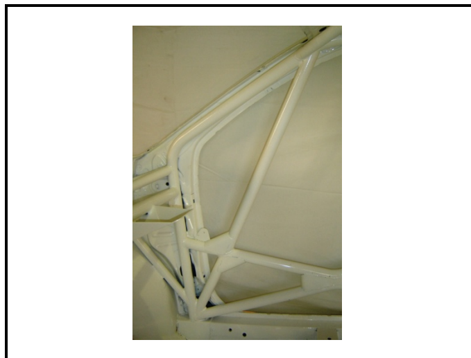
SC-6) Renfort de montant de pare-brise – Vue d'ensemble Windscreen pillar reinforcement – General view
