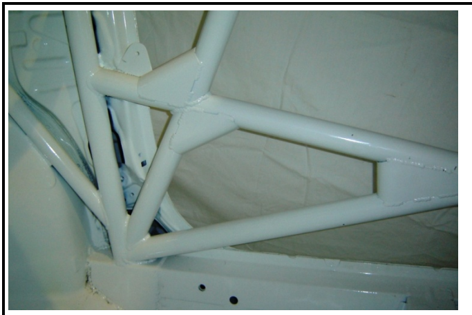
SC-21) Entretoises de portes – Jonction avec arceau principal Doorbars – Junction with main rollbar
