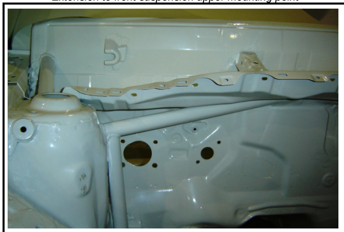
SC-32) Extension vers point d'ancrage sup. de suspensions avant Extension to front suspension upper mounting point
