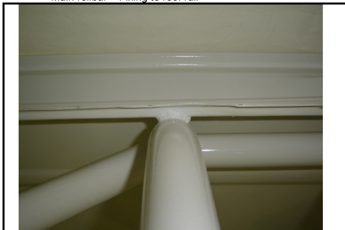
SC-15) Entretoises diagonales – Jonction avec arceau principal Diagonal members – Junction with main rollbar
