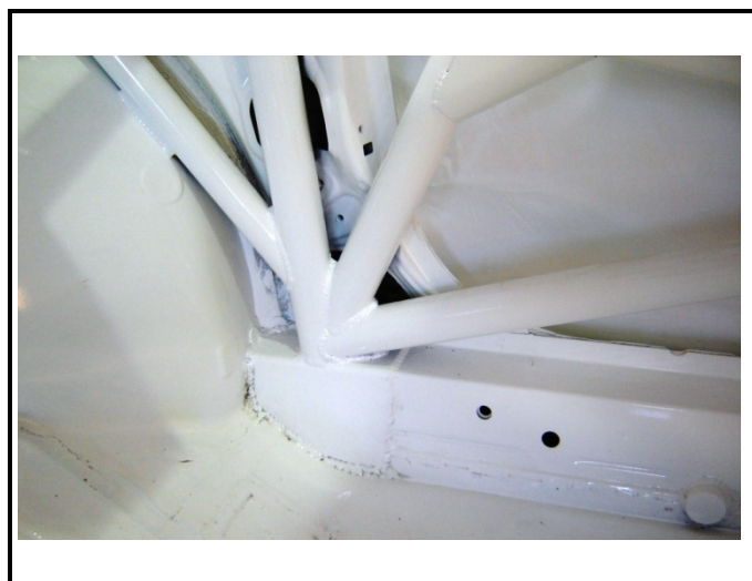
SC-6) Renfort de montant de pare-brise – Vue d'ensemble Windscreen pillar reinforcement – General view
