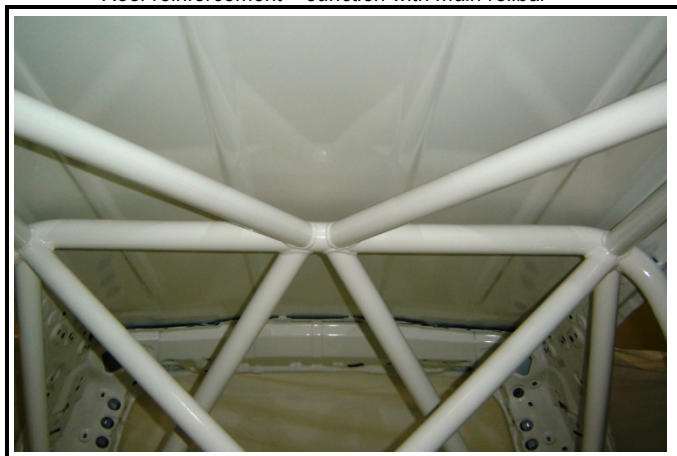
SC-28) Jambes de force arrière – Ancrage sur la coque Backstays – Mounting on bodyshell
