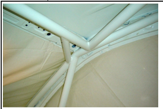
SC-9) Renfort montant pare-brise- Jonction avec entretoise de porte Windscreen pillar reinforcement- Junction with doorbar
