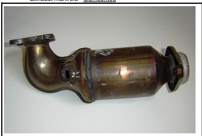
C12-1) Collecteur d'échappement - déposé Exhaust manifold - dismounted
