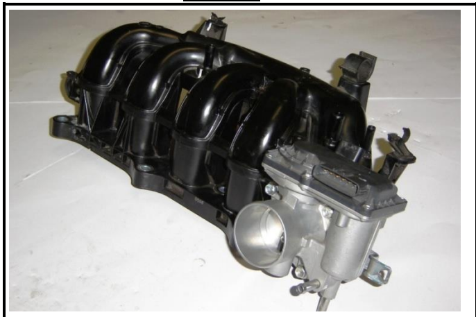
C11-3) Boitier papillon - déposé Throttle unit - dismounted
