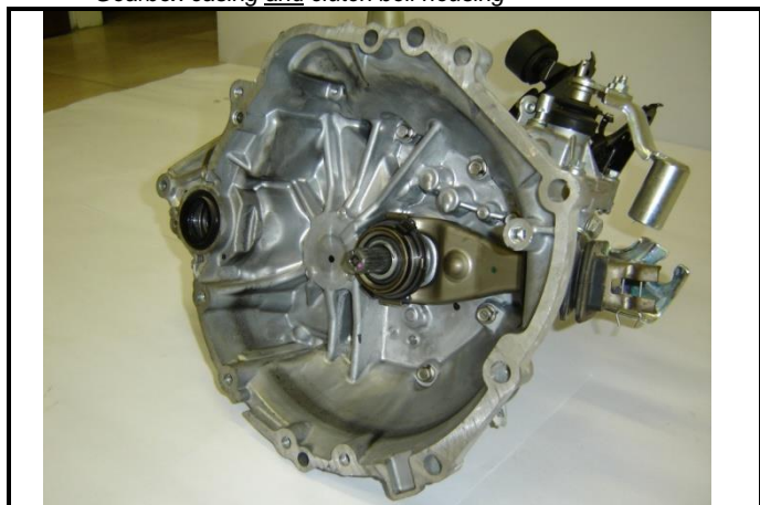
F2-1) Carter de boîte de vitesses et cloche d'embrayage Gearbox casing and clutch bell housing
