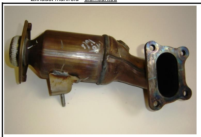
C12-2) Collecteur d'échappement - déposé Exhaust manifold - dismounted
