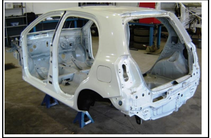
N1-4) Châssis nu – Habitacle vu à travers la baie de pare-brise Bare chassis – Cockpit seen from windscreen opening
