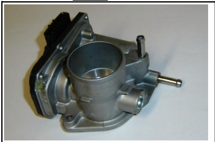
C11-3) Boitier papillon - déposé Throttle unit - dismounted
